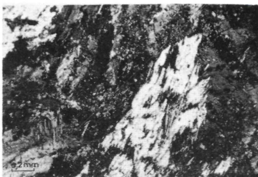
Foto 2. Pôvodná gabroofitická štruktúra, metlovité zatlačanie plagioklasu velonoblastmi aktinolitického amfibolu. Stredno-zrnný bazalt jedloveckého príkrovu; XN (vz. 55/140,5)
